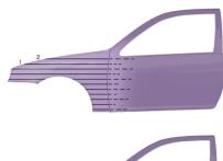
Den Grundfarbton auf den gefüllerten Bereich auftragen. Einzelne Spritzgänge mit Zwischenabluft. Jeden Spritzgang etwas weiter auslegen so dass Deckfähigkeit erreicht wird.
