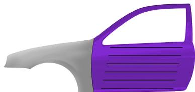
Élément adjacent : poncer l'élément avec l'abrasif adapté par ex. Trizact – P1000. Pièce neuve poncer l'apprêt au P500.
